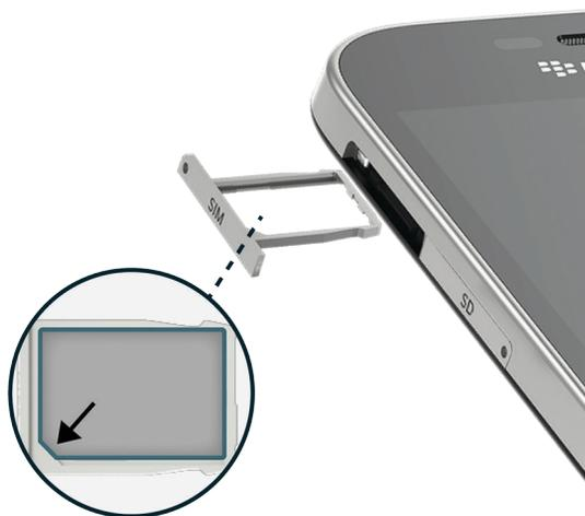
5. Задвиньте дверцу внутрь устройства.
