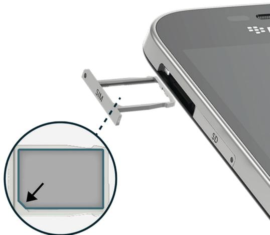
3. Задвиньте лоток **SIM-карты** в гнездо устройства.
