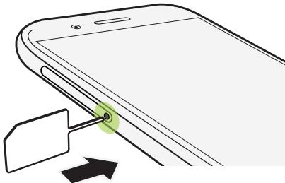
При вставке инструмента для выдвижения лотка в соответствующее отверстие не блокируйте лоток, чтобы избежать повреждения выдвижного механизма внутри слота.
