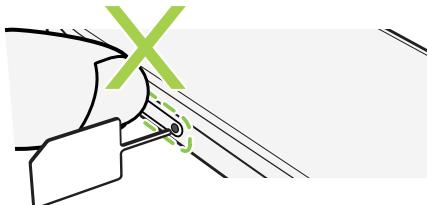
3. Нажмите кончиком инструмента внутрь отверстия до упора, чтобы выдвинуть лоток, а затем вытяните лоток наружу.
