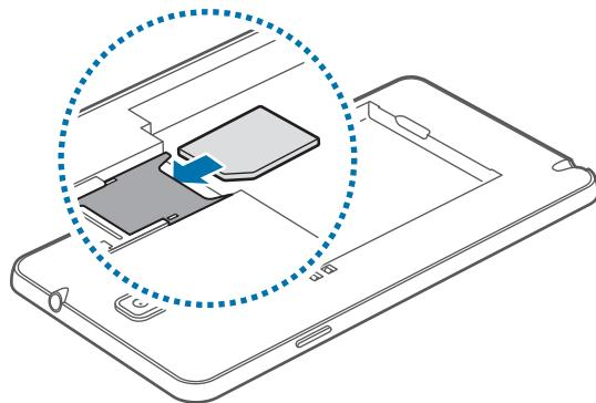
**3** Нажмите на SIM- или USIM-карту до щелчка, чтобы зафиксировать ее в разъеме.
