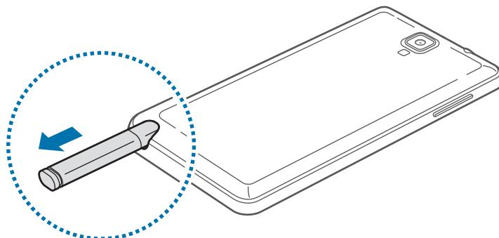
При извлечении пера S Pen из гнезда устройство обнаружит это событие и выполнит следующие действия.
